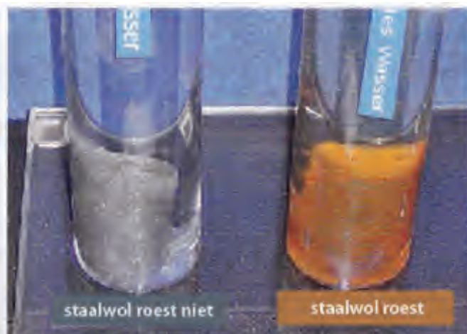
Afb. 35: basisch actiefwater voorkomt roest
